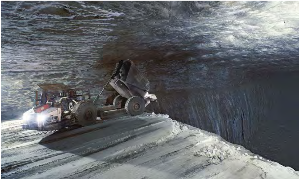
Sturzversatzverfahren, Quelle: REMONDIS
