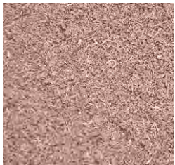
HMV-Schlackeaufbereitung, Schwerfraktion aus NE-Gemisch, Quelle: Breer
