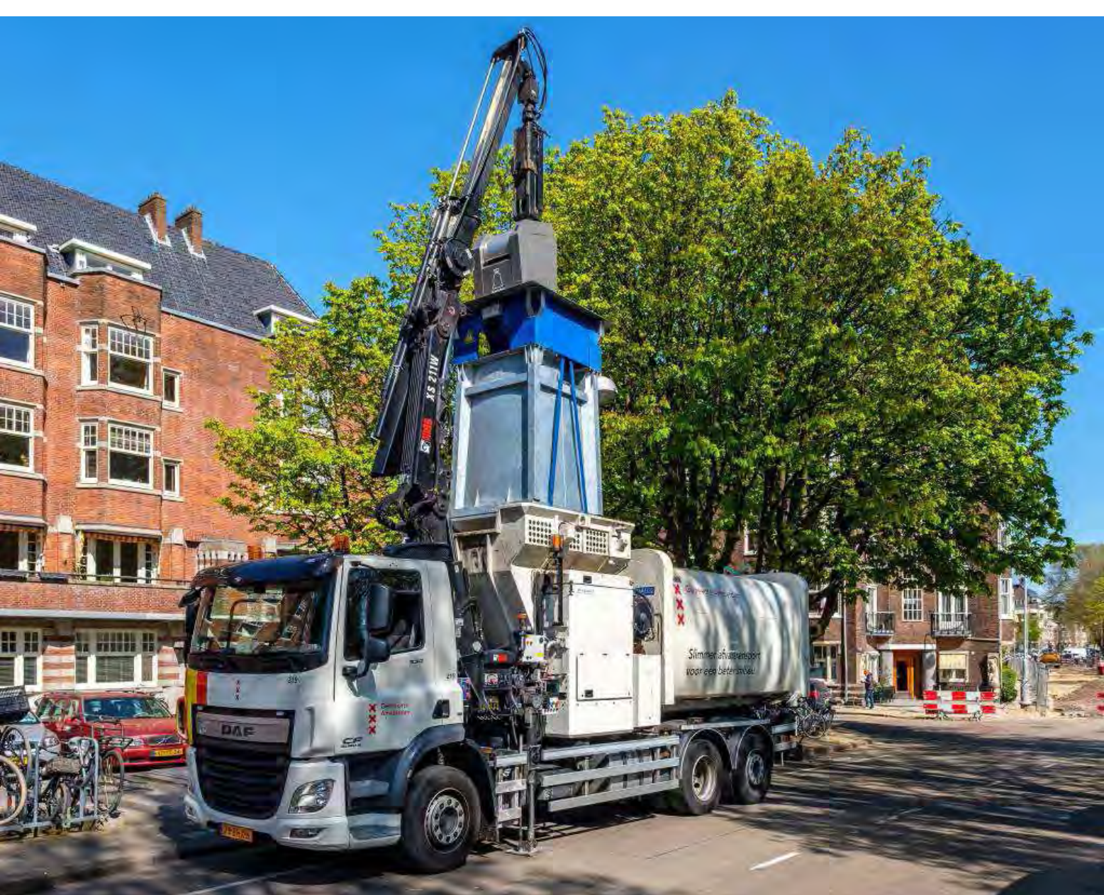
Entladen eines Unterflurpress- container, Quelle: SIDCON
